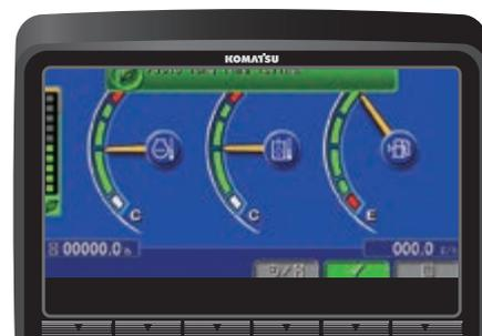
*Indicatore Eco, guida Eco, avviso di motore al minimo ed un dispositivo regolabile di spegnimento automatico in folle per ottimizzare ulteriormente il consumo di carburante*
