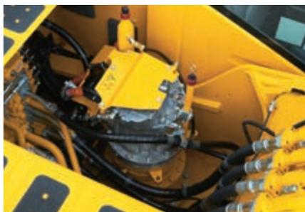
**Motore di rotazione elettrico-generatore**
