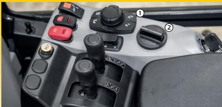
Comandi di nuova progettazione. Il selettore comandi (1) consente una navigazione pratica tra i menù del monitor, proprio come in un'automobile. Il nuovo selettore della velocità di traslazione (2) mantiene costante la velocità della macchina quando si trasla in discesa.
