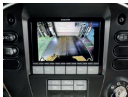
*Sistema di telecamera posteriore completamente integrata*
